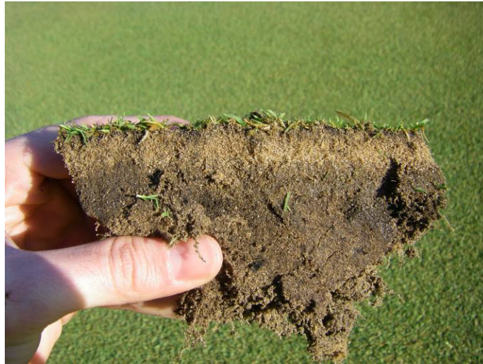
Foto 2. Cata de un green. En ella se pueden observar las distintas capas de distintos tipos de materiales.
