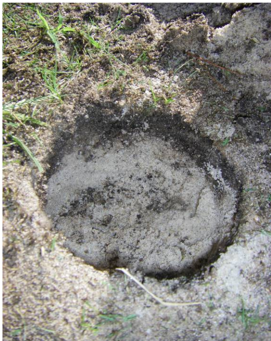
Fotos 4 y 5. Detalles de las diferentes catas realizadas en los tees donde se puede observar la capa negra ( black layer ).
