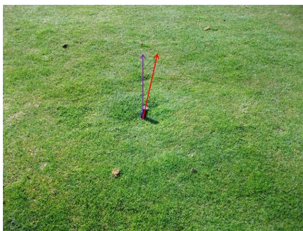
Foto 1.9. En color rojo la inclinación del aspersor respecto con la vertical (color violeta). Este hecho provoca un solape desigual además de una baja uniformidad en el riego
