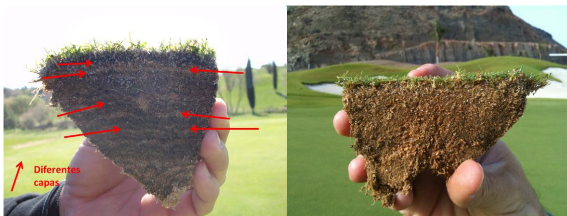
Foto 1.11. A la izquierda perfil del Green de la Dehesa con estratificación de capas. A la derecha perfil de otro campo de golf sin estratificación de capas
