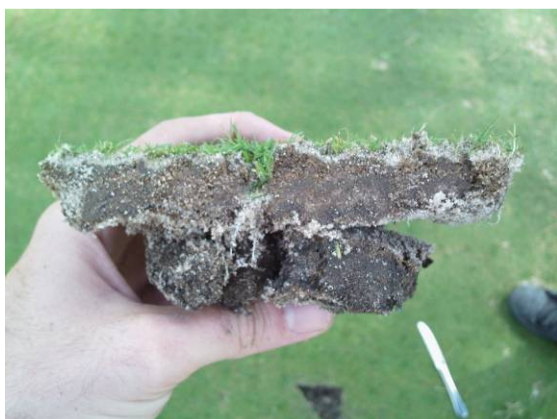
Foto 4. Cata del green #2 donde se puede observar la diferencia entre los materiales que forman el perfil del green.
