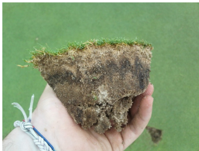
Foto 2. Cata de un green donde se observa capa negra (black layer).
