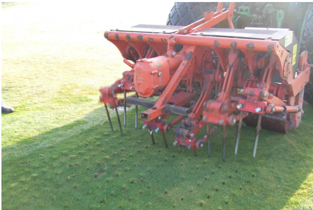
PINCHADO DE CALLES CON VERTIDRAIN
