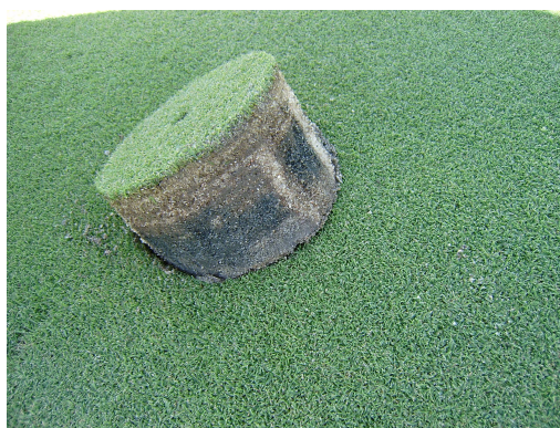
Foto 9. Capas en la cata de un green
