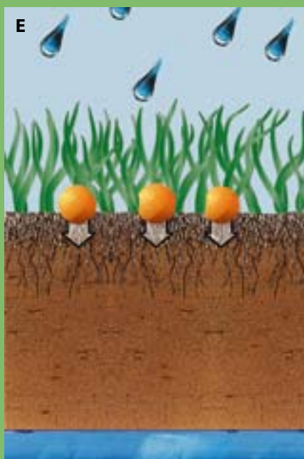
E. Los gránulos liberan cada día una cantidad de nutrientes necesaria y suficiente. La lluvia sólo lixivia una cantidad mínima de los nutrientes que la planta no ha absorbido: por término medio, un 5% del nitrógeno aportado anualmente.
