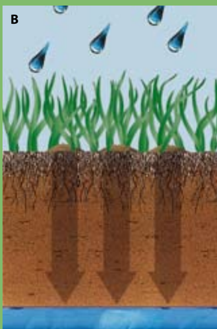
B. La lluvia y el agua de riego lixivian fácilmente los nutrientes disponibles en exceso, transportándolos hacia el agua subterránea, por lo que la planta ya no puede disponer de los mismos. Esto afecta, por término medio, al 30% del nitrógeno aplicado anualmente.
