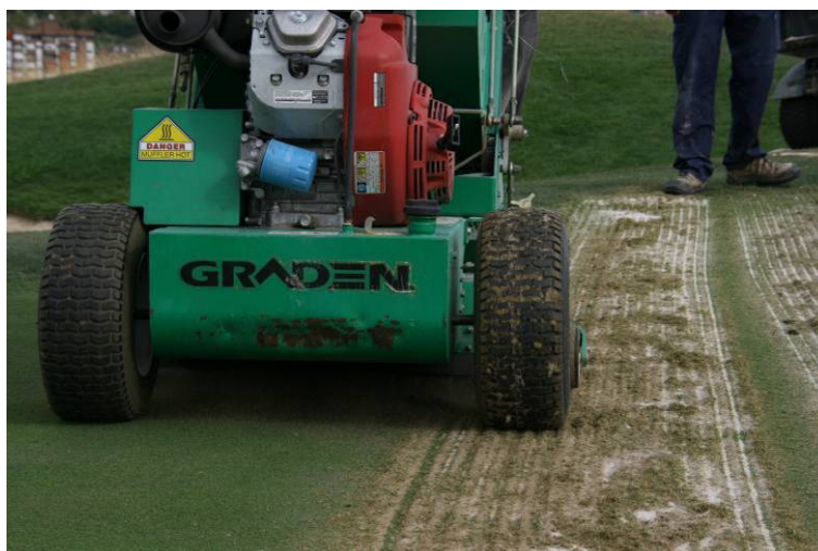
Fig.10 Detalle de la graden en funcionamiento y de los canales creados por esta.
