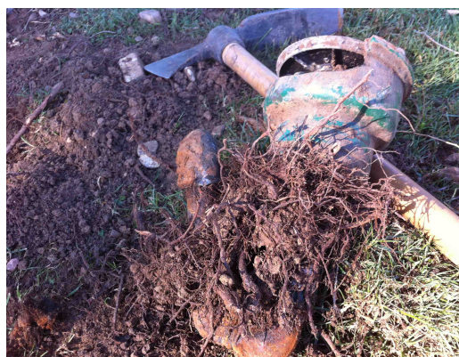
Foto 8: Detalle de el estrangulamiento al que se ven sometidos los aspersores por las raíces de los árboles.
