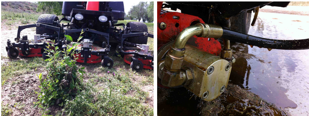
Foto 6: Detalle de rotura de quítuple de calles (Izq) y rotura de hidráulico en tripleta de antegreens (Dcha)
