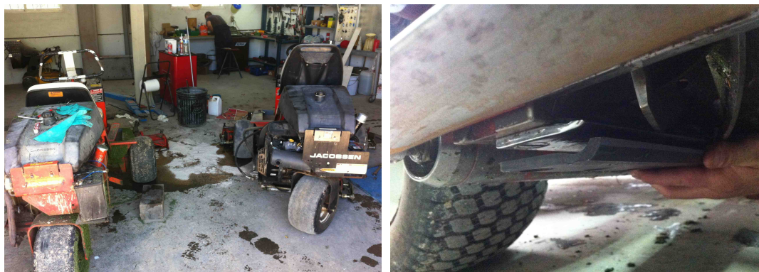
Foto 11: Detalle de máquinas averiadas (Izq) y necesidad de cambio de cuchillas mediante la comparación de una cuchilla base puesta con una nueva (Dcha).
