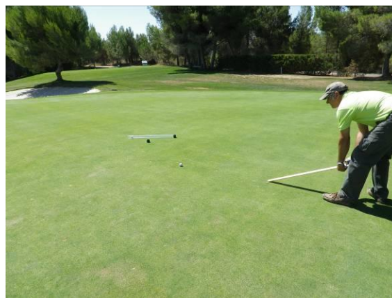
Foto 2. Midiendo la velocidad de un green.
