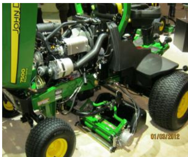
Figura 4. Molinetes gobernados por motores eléctricos
