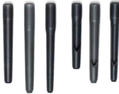
Foto 2. Izq. Pinchos huecos de expulsión superior. Dcha. Pinchos huecos de expulsión lateral.
