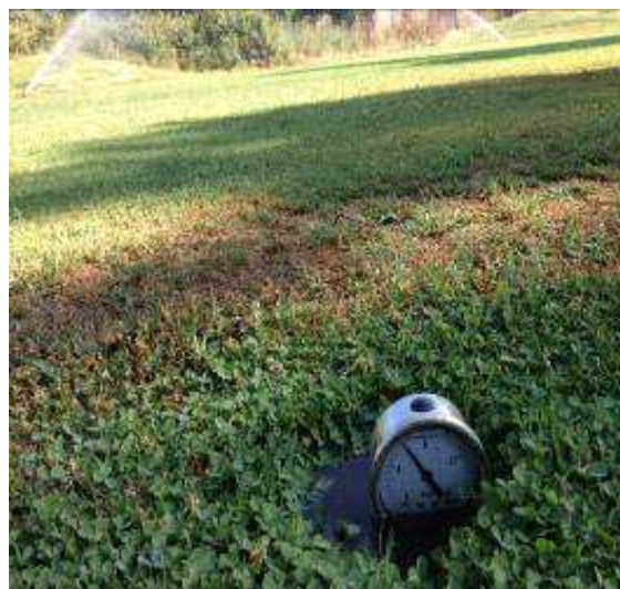
Oscilación de presión por el mal funcionamiento del variador de las bombas
