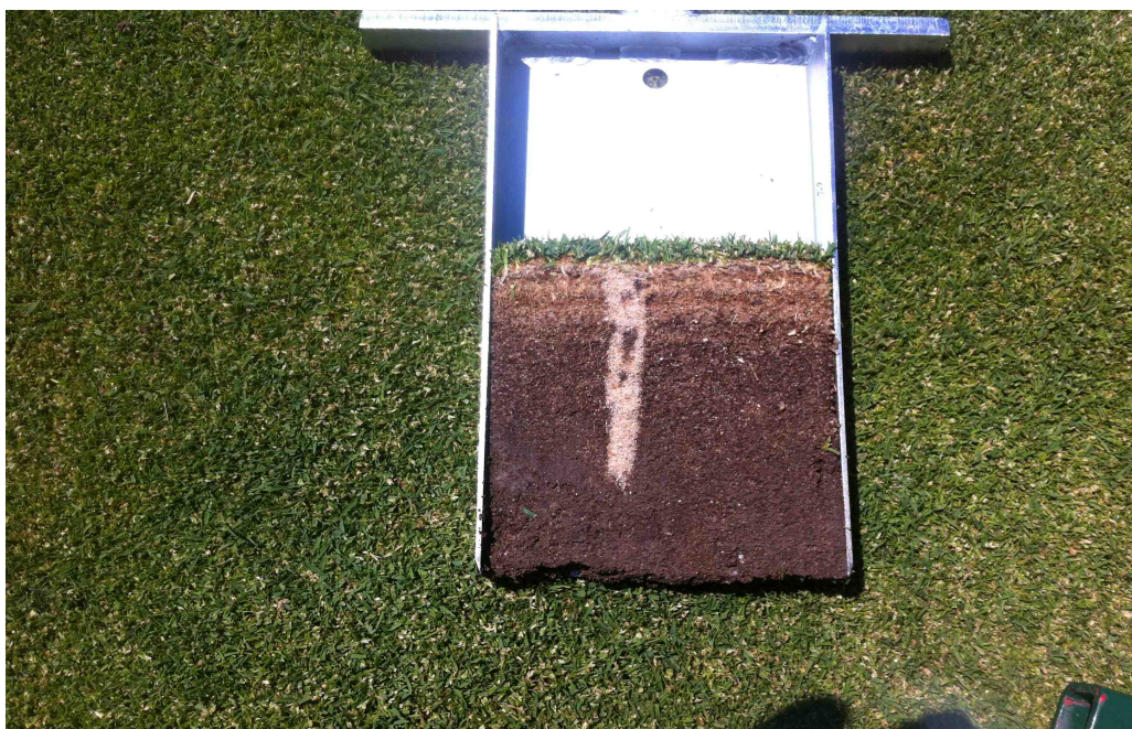
Foto 4: Detalle del perfil del suelo. Nótese la gran labor del pinchado, al mejorar el intercambio de agua y gases, y permitir el crecimiento radicular, entre otras ventajas.
