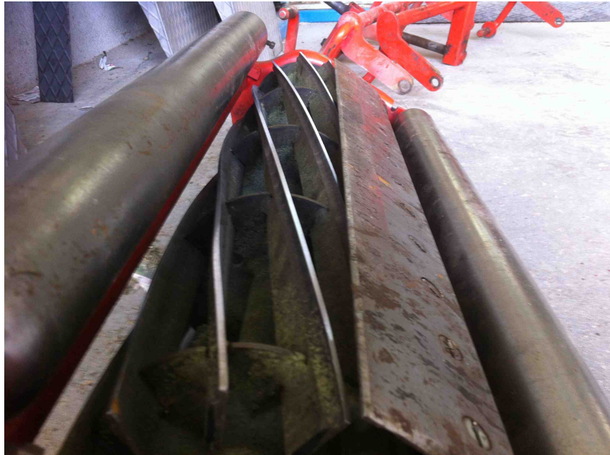
Foto 13: Detalle del rectificado d molinetes por el equipo de mecánicos del campo de golf.
