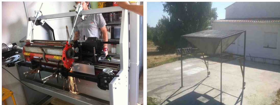
Foto 13: Detalle de la máquina rectificadora (Izq) y de la criba de áridos (Dcha).
