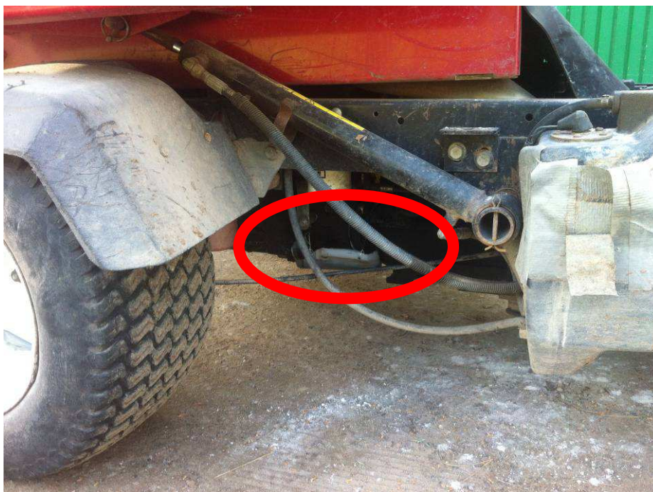
Foto 9. Vehículo con fuga de aceite.
