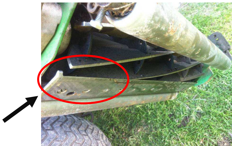
Foto 11. Desgaste de la contracuchilla.
