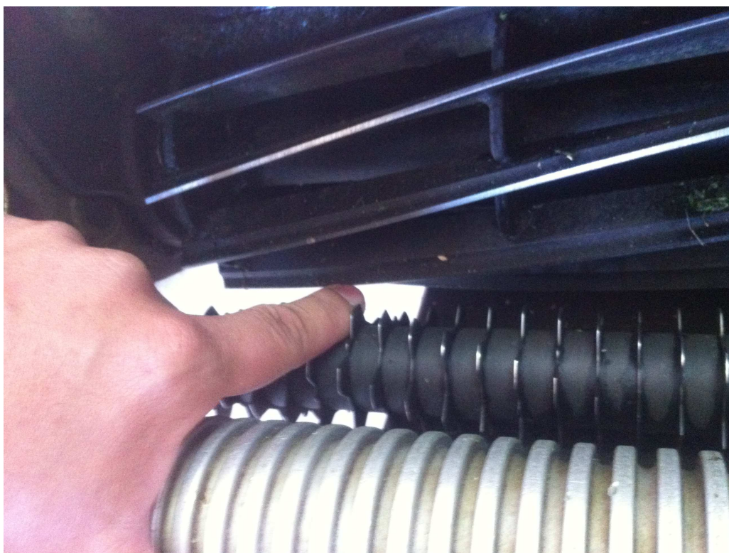
Foto 1. Cuchillas de groomers desgastadas.
