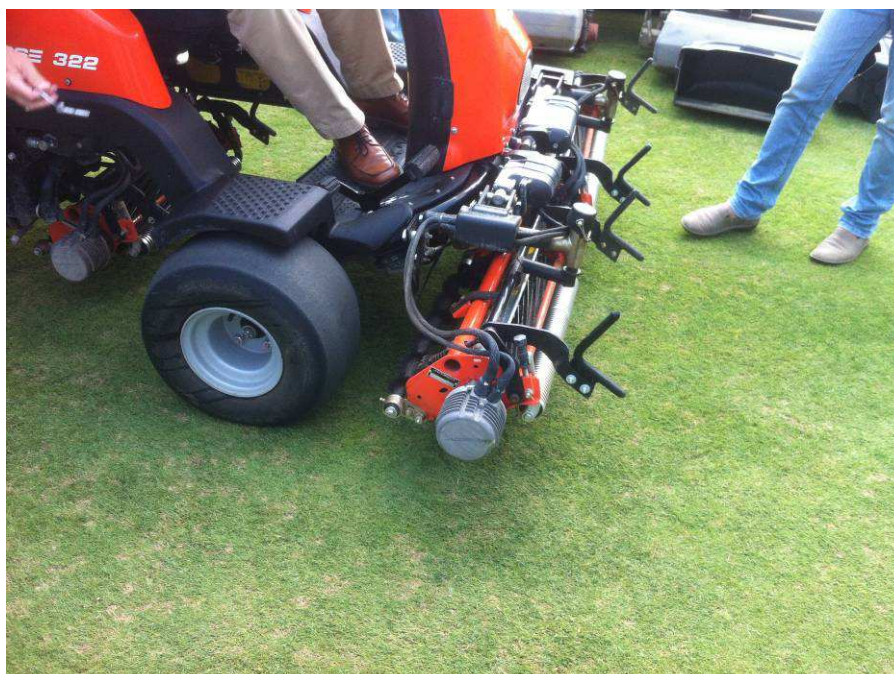
Foto 4. Unidades de corte y traslación eléctricas.
