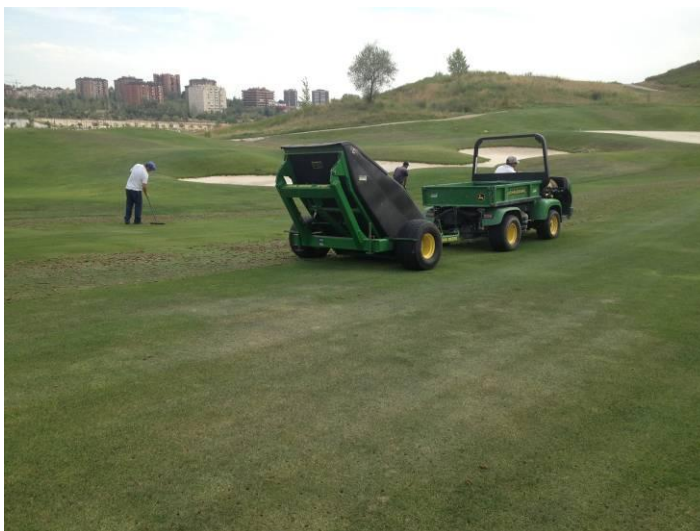
Foto 14. Recogida de restos del pinchado mediante barredora.
