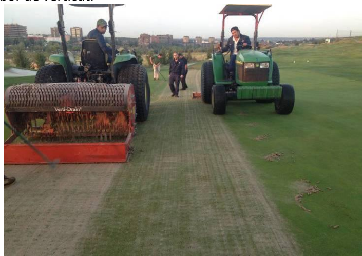
Foto 2. Pinchado hueco en green mediante Vertidrain.
