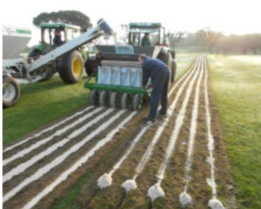
Imágenes 22 y 23: Máquina trabajando junto con la tolva de incorporación de arena y aspecto final que presentan las calles una vez realizada la labor.
