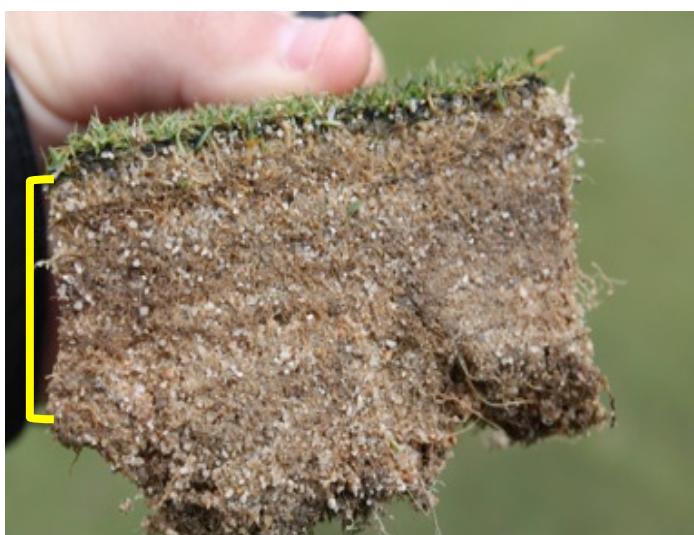
Foto 6: Perfil de suelo del green con un elevado colchón de materia orgánica, y esquema de las especificaciones de diseño para greens USGA.
