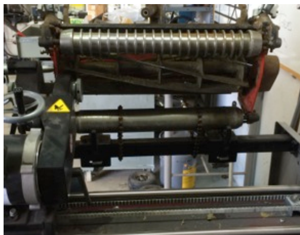
Foto 9: Detalle de la reparación de un rodillo de una máquina de calles (Izq.) y del rectificado de molinetes (Dcha)
