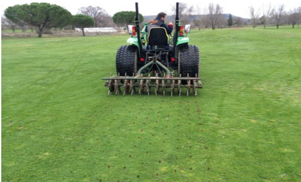
Foto 8: Detalle de prueba de pinchado sobre calle con pincho macizo.
