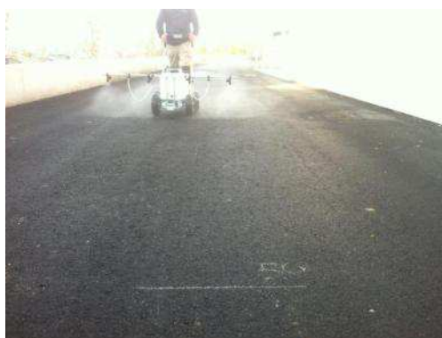
Fotos 1, 2, 3 y 4. Calibración del equipo de tratamiento en greens.
