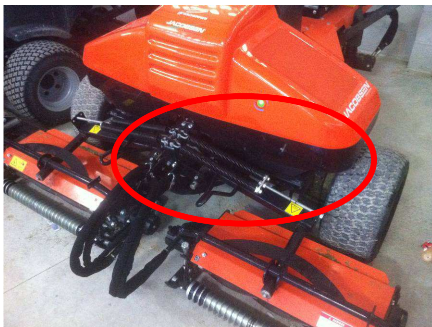
Foto 12. Muelles de compensación de las unidades de corte.
