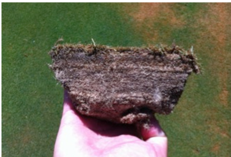
Foto 3: Pérdida de estructura del suelo (layering) provocado por la acumulación de materia orgánica, formación de capa negra e incorporación de arena de recebo de granulometría fina.
