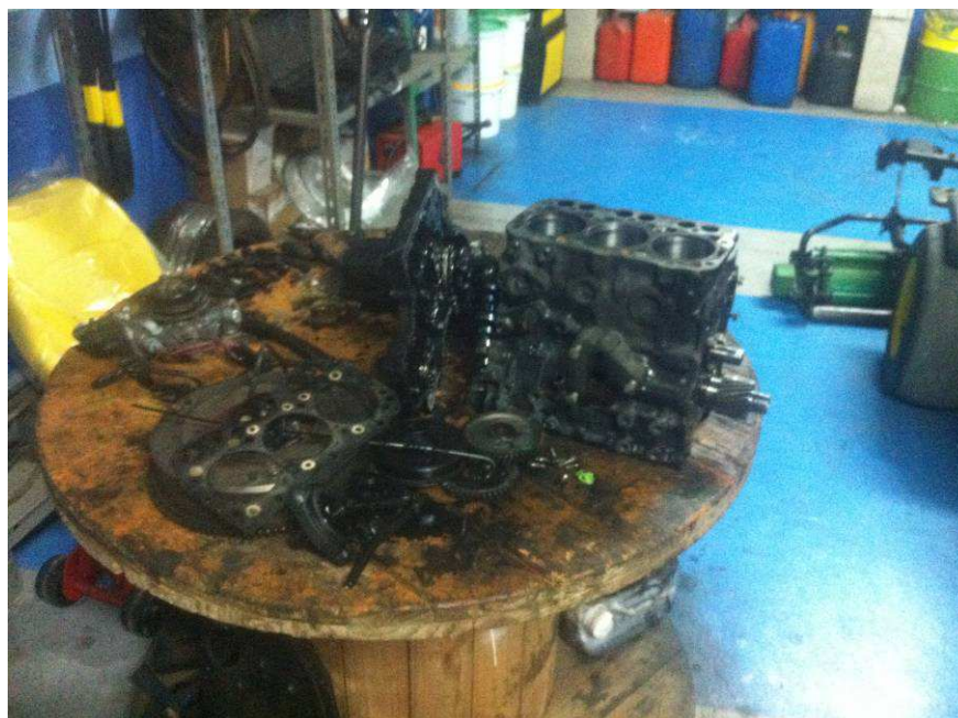
Foto 16. Motor de vehículo multiusos desmontado.
