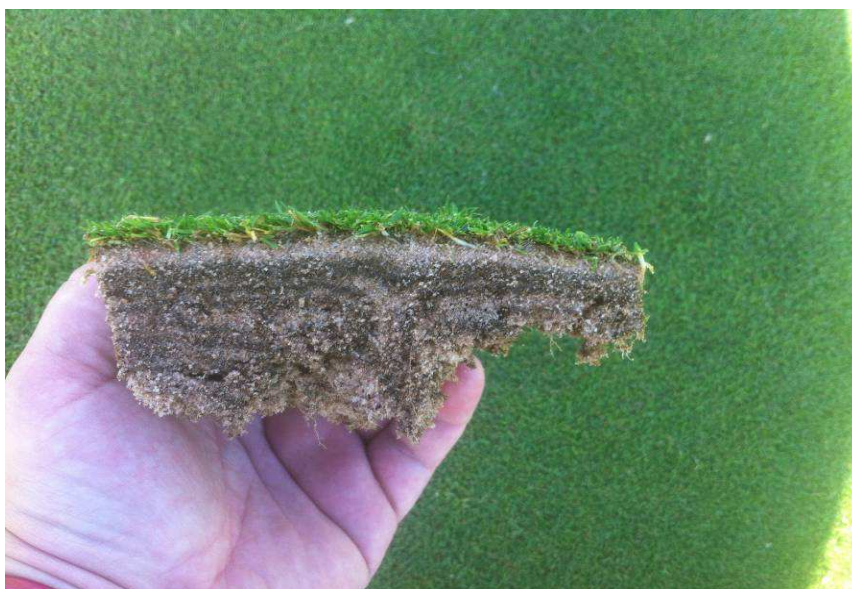
Foto 4. Cata realizada en el perfil de la zona radicular.
