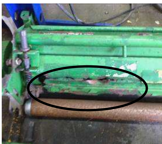
Corrosión en unidades de corte
