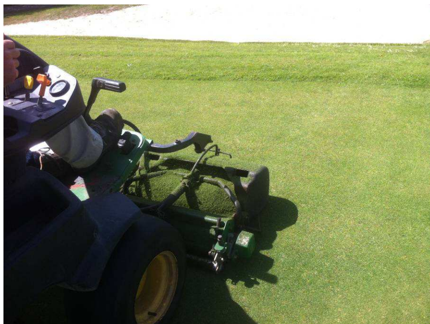
Foto 7. Llenado de los cajones recogedores de restos de siega.
