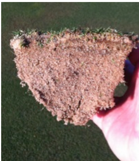
Fotos 3 y 4: Diferencia en el contenido de humedad en el suelo. A la izquierda, cata de suelo realizada sobre una zona sana con el perfil completamente húmedo; a la derecha, cata de suelo realizada sobre una zona seca. En esta última, se aprecia el terreno completamente seco y un
