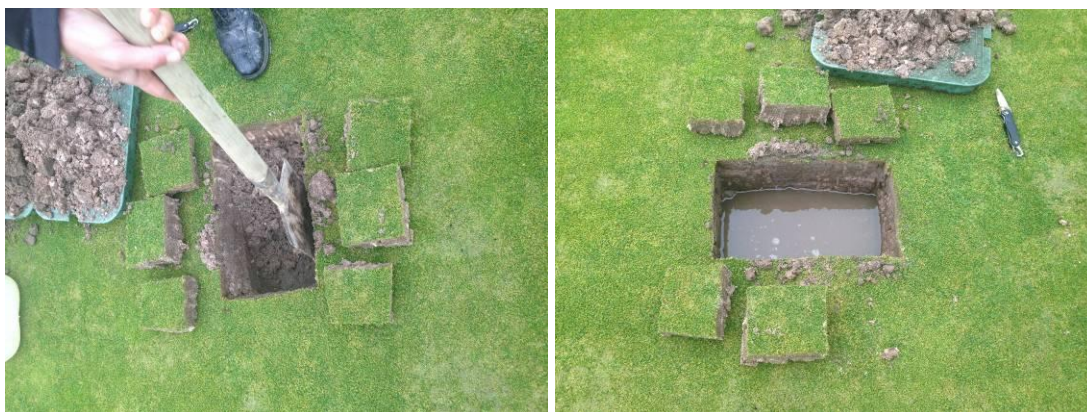
Foto 10 y Foto 11. Realización de prueba de infiltración en un green del recorrido.
