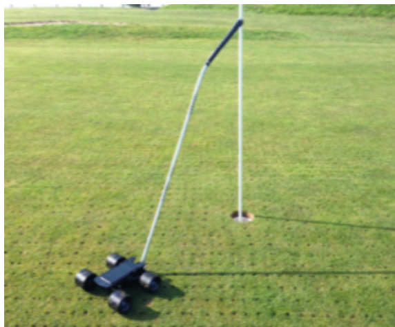
Imagen 1. Parry Meter preparado para realizar el test de rodadura.
