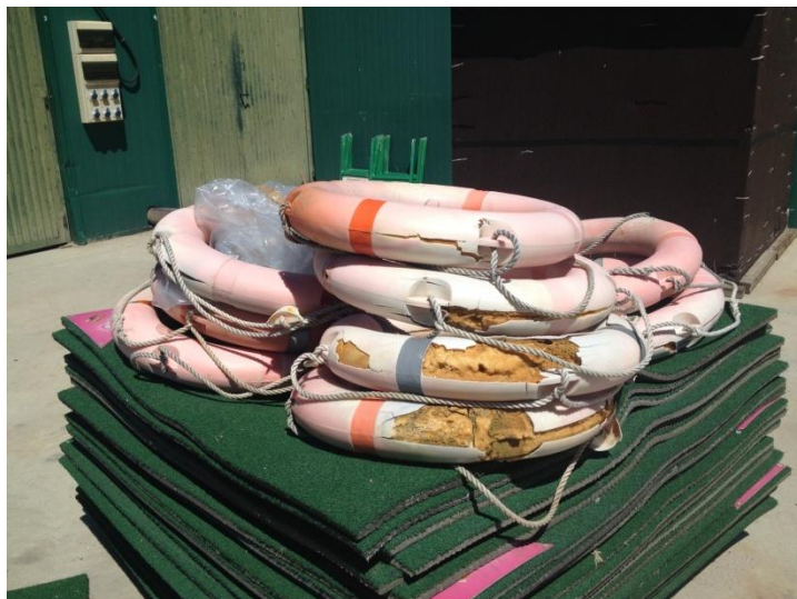
Imagen 10. Flotadores antiguos deteriorados que han sido sustituidos.
