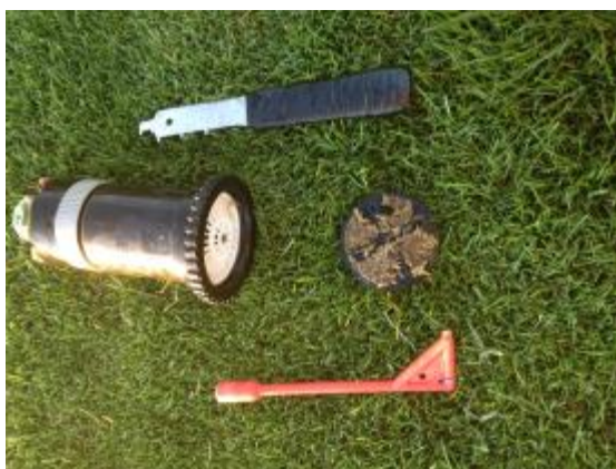
Detalle de aspersores completamente atascados
