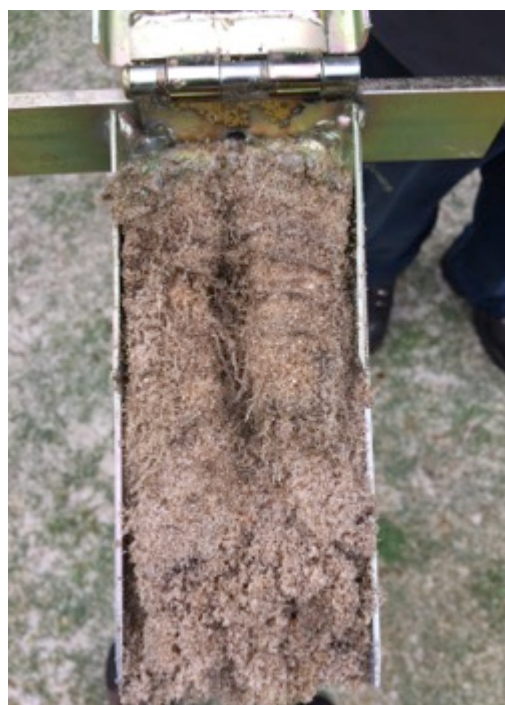
Imágenes 2-3: Catas de suelo realizadas en los greenes del campo. La de la izquierda muestra un perfil con un alto contenido de materia orgánica y capa negra. La de la derecha muestra gran fieltro superficial que impide la infiltración del agua en profundidad, mostrando un perfil radicular seco sin humedad en la arena.
