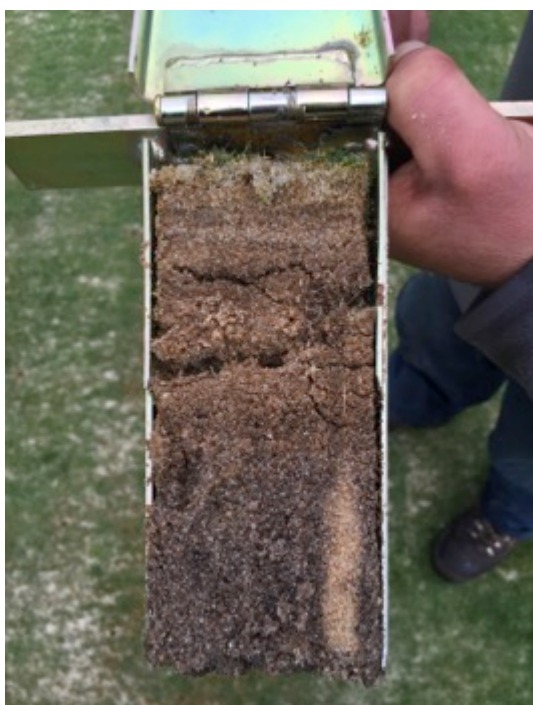
Imágenes 2-3: Catas de suelo realizadas en los greenes del campo. La de la izquierda muestra un perfil con un alto contenido de materia orgánica y capa negra. La de la derecha muestra gran fieltro superficial que impide la infiltración del agua en profundidad, mostrando un perfil radicular seco sin humedad en la arena.
