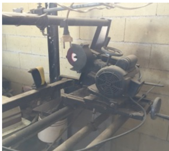
Fotos 11-12: Rectificadora de unidades de corte.
