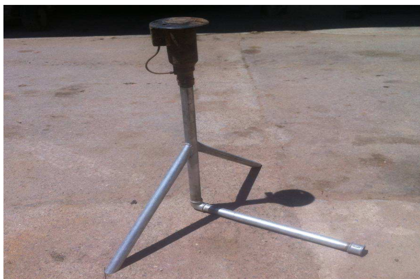
Foto 14. Trípode de reparación y prueba de aspersores.
