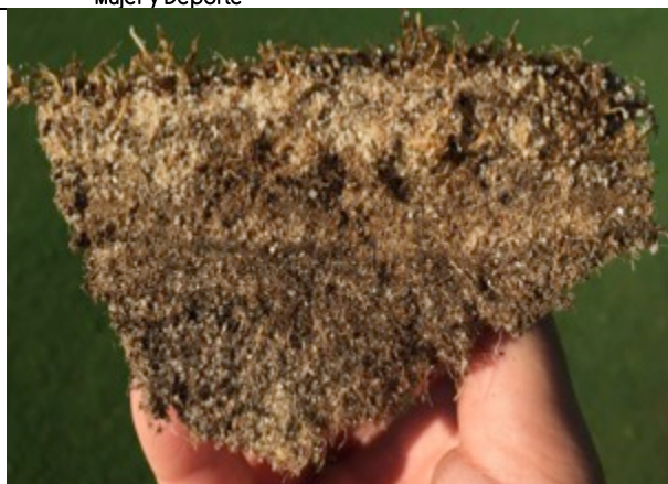
Imágenes 3-4. Perfil de suelo que muestra el alto porcentaje de materia orgánica y la capa inferior compactada que impide la infiltración de agua, provocando las secas que se observan en los greens.
