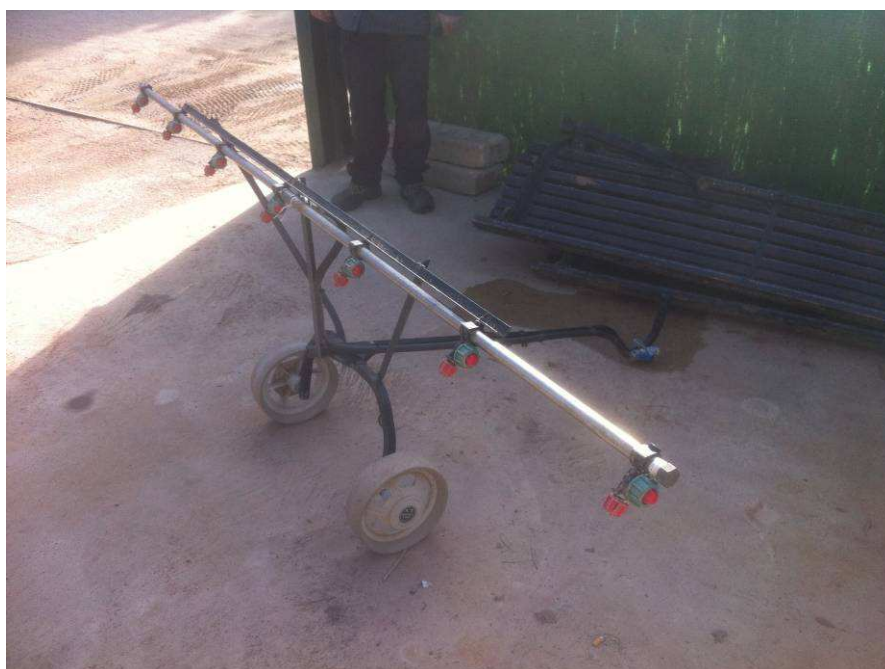
Foto 13. Accesorio para aplicaciones construido sobre un carro de golf.
