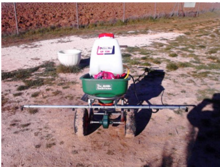
Foto 14: Equipo de pulverización fabricado con la mochila adquirida sobre la abonadora.
