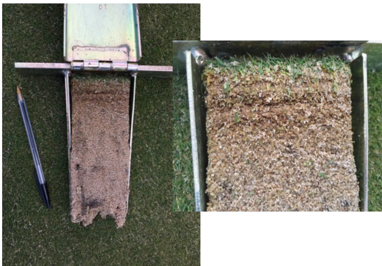
Foto 6-7: Detalle del perfil arenoso del green, con la capa de fieltro (thatch) generada por el crecimiento agresivo de esta variedad.
