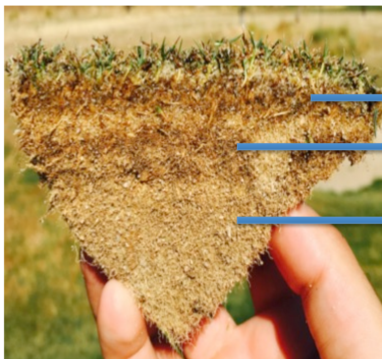
Imagen 3: Cata de suelo donde se aprecia claramente el perfil completamente compactado y la capa de enraizamiento completamente seca.
