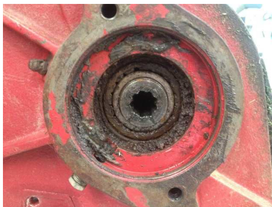
Rodamiento gripado por falta de engrase
