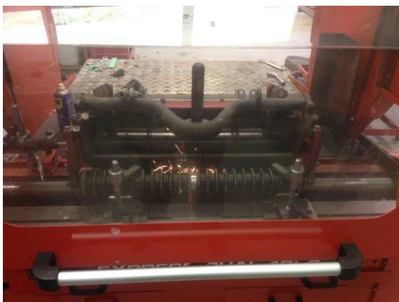
Rectificado de unidad de corte
