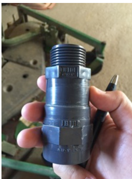
Imagen 16-. Conjunto de piezas de PVC para elevar los aspersores.
